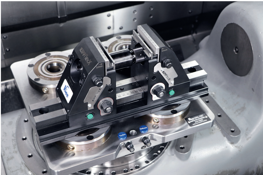
2 Für unkomplizierte Rüstvorgänge kann der KippflexX direkt auf dem Unilock Nullpunkt-Spannsystem montiert werden © Kipp
